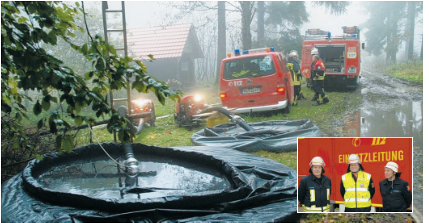
Im Nebel: Mit schwerem Gerät wurden bei der Übung der Bezirksreserve im dichten Nebel mitten im Wald bis zu 10 Kubikmeter fassende Löschwasserbehälter aufgestellt. Die überdimensionalen Kunststoffsäcke blähen sich beim Befüllen mit Wasser selbstständig auf. Die Übungsleiter (kleines Foto) Willi Schrenner (l.) und Johannes Benning (r.) hatten die Pläne erstellt, nach denen Einsatzleiter Elmar Keuter den Einsatz der Bezirksreserve koordinierte.
